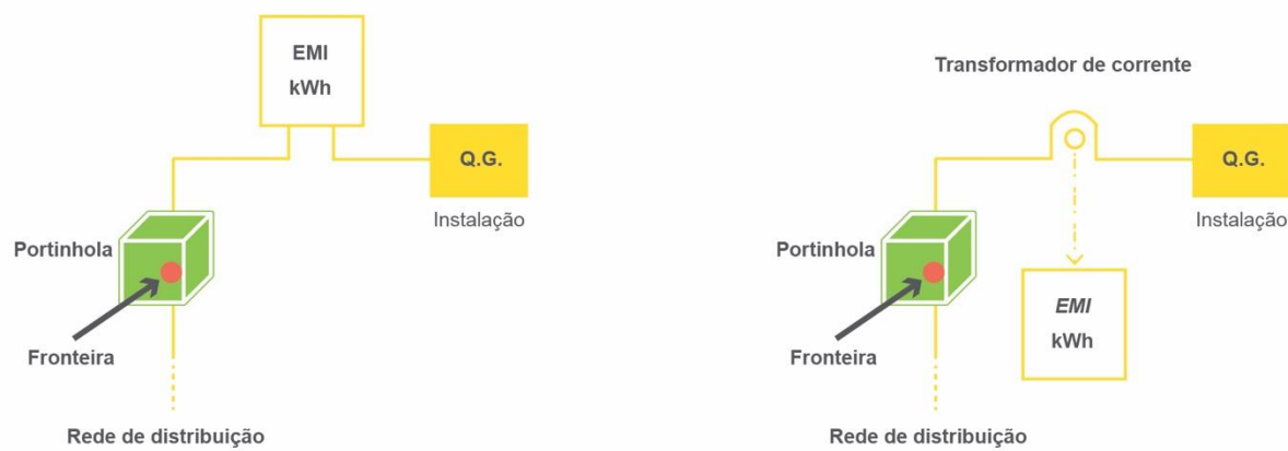
Figura 5. 2 - Ponto de fronteira entre a Rede Pública e a Instalação particular do tipo BTN (esquerda) e BTE (direita)
